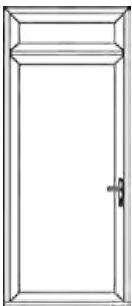
L'imposte (l'imposte peut également être cintrée)
